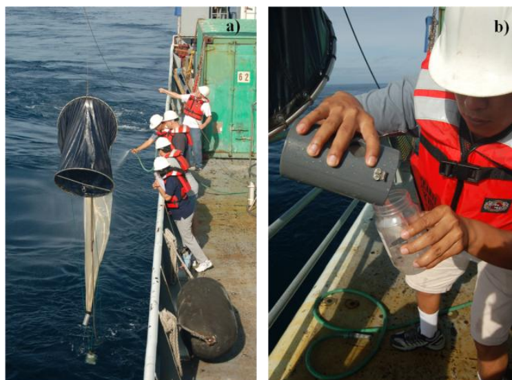
Fig. 2. a) Lance vertical de la red de cierre a diferentes estratos de profundidad y b) recolección de muestra de zooplancton.
