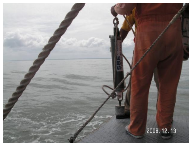
Fig. 4.-El equipo CTD, listo, antes de lanzarlo al mar.
