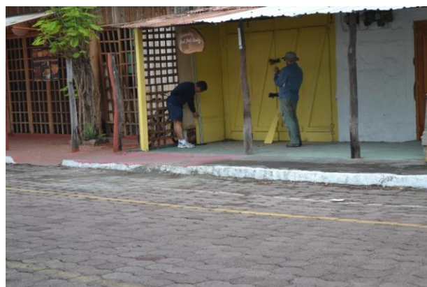
Figura 27 Medición del run-up realizada sobre una línea de marca de agua en la ciudad de Puerto Ayora-
