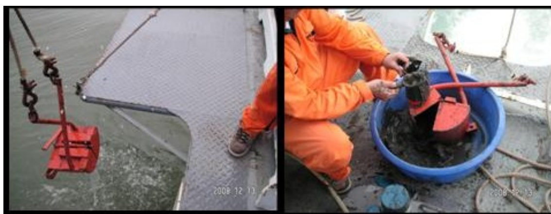
Figura 6.- Draga Van Veen (izquierda) subiendo y con el sedimento (derecho)
