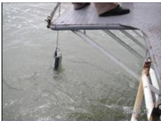
Figura 3.- CTD estabilizándose e iniciando el programa antes de registrar los parámetros
